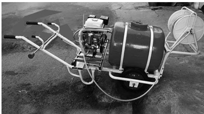
Hình 98: Máy phun thuốc có động cơ phun theo nguyên tắc áp suất
