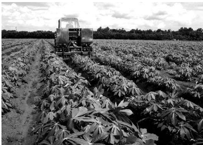
Hình 86: Máy xới - bón phân cho sắn đang hoạt động 1
