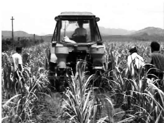
Hình 84: Máy xới - bón phân cho mía XBM - 2 - 1,2 đang hoạt động 1
