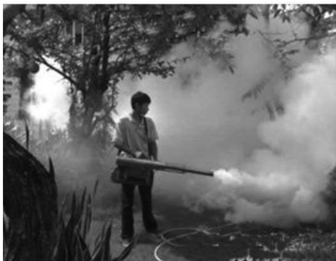
Hình 100: Máy phun thuốc trừ sâu dạng khói PulsFog K10SP
