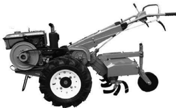
Hình 42: Máy phay liên hợp với máy kéo Bông Sen 12
