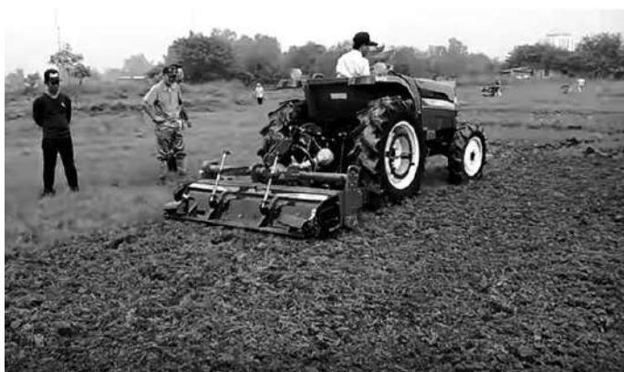
Hình 44: Máy phay có lưỡi dao cong làm đất ruộng khô
