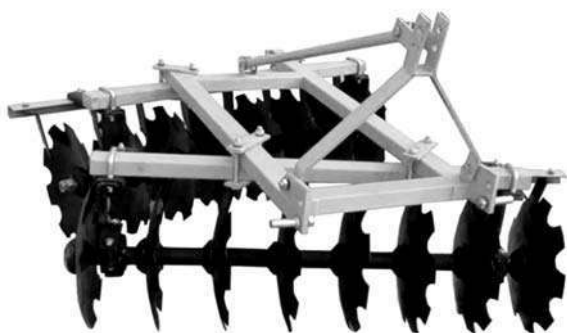
Hình 35: Máy bừa hai mảng đĩa bố trí theo sơ đồ hình chữ V nằm ngang
