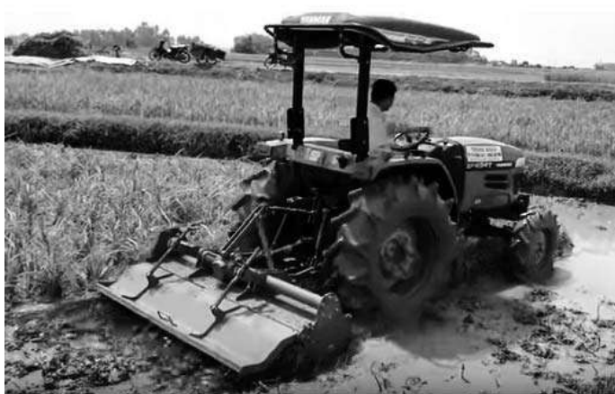
Hình 43: Máy phay có dao cong làm đất ruộng nước
