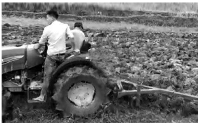
Hình 25: Máy cày bốn thân xá nhỏ liên hợp với máy kéo bốn bánh
