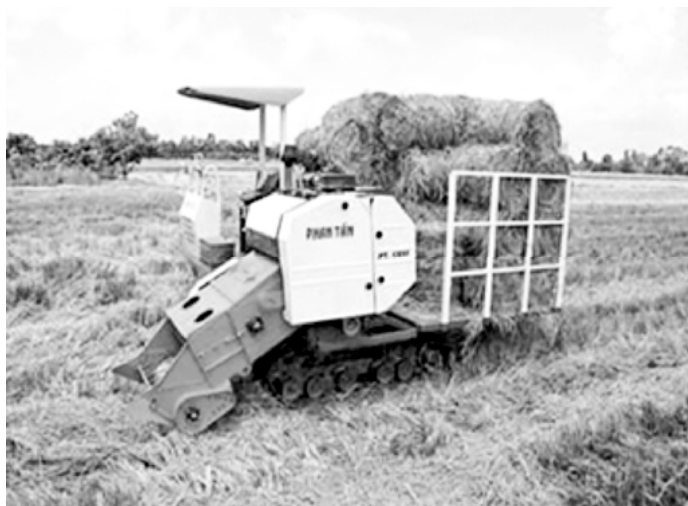
Hình 5.14: Máy cuốn rơm tự hành do Việt Nam sản xuất
