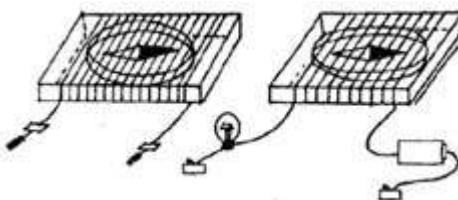
Đặt hộp kim chỉ nam vào một hộp nhựa hoặc hộp bìa cứng, có kích thước như vỏ bao diêm, dùng dây buộc quấn quanh nó 40 vòng, dùng dí băng keo cố định một phía bên của hộp, hai đầu dây để dài ra thêm 200mm và cách mỗi đầu 20 mm dùng dao nhỏ cạo đi lớp bọc sơn rồi quấn vào chiếc ghim sách bằng kim loại, dùng băng keo trong để cố định.
