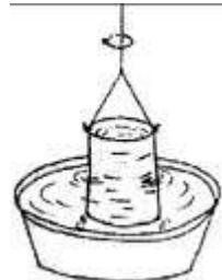
Sau đó, nhúng túi vào chậu nước có chứa đầy nước, dùng tay cầm dây nâng chiếc túi lên thì chiếc túi vừa phun nước ra, và quay tròn theo hướng ngược với hướng nước phun ra?
