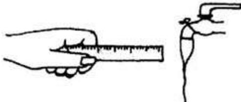
Quay đầu thước lại ( ngược hướng cũ) thì dòng nước cũng chảy lệch đi. Nếu đưa thước chạm vào dòng nước thì nó không còn hút dòng nước nữa.
