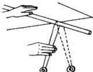
Sau đó, kéo lên rồi thả xuống để vòng sắt đung đưa. Khi thấy động tác kéo thả đó đã nhịp nhàng với dao động của vòng sắt thì vòng sắt sẽ đu đưa chẳng khác gì người ta đánh đu vậy.
