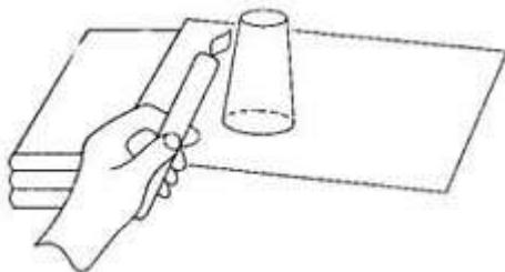
Giải thích: Do khi dùng lửa hơ nóng đáy chiếc cốc thì không khí trong chiếc cốc dần dần giãn nở vì nhiệt , muốn thoát ra ngoài chiếc cốc . Nhưng miệng cốc đã bị lật úp, lại có một lớp nước bít kín miệng cốc , không khí nóng không thoát ra nổi , chỉ có cách phải đội chiếc cốc lên . Và như vậy, cộng thêm tác dụng của trọng lượng tự thân, chiếc cốc trượt xuống theo chiều nghiêng đặt miếng kính.
