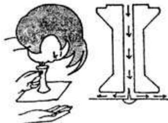
Khi bạn dùng sức để thổi thì dòng khí tốc độ cao sẽ thoát ra từ khe hở giữa phần dưới lõi chỉ và tờ bìa. Khí áp chỗ khe hở đó nhỏ hơn khí áp ở mặt dưới của tờ bìa, do đó tờ bìa bị không khí phía dưới nâng lên, không rơi.
