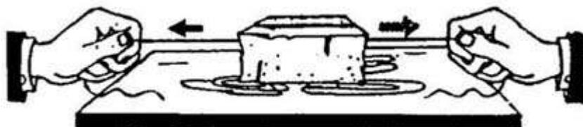
Do giữa sợi dây sắt và tảng nước đá đã xảy ra tác dụng quan trọng là ma sát. Nhiệt lượng sinh do ma sát làm chỗ tảng nước đá bị “cưa” nóng chảy thành nước, do đó dây sắt nhỏ có thể di động chậm chạp trong tảng nước đá.
