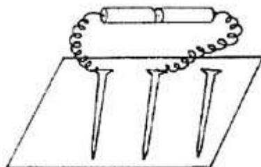
Kim loại gì là do bị ô xy hoá mà trong phản ứng kim loại bị ô xy hoá thực chất là mất electron. Để mất electron nên dễ bị gỉ. Sau khi nối kim loại với dòng điện một chiều ở cực dương, do dòng điện hoạt động, quá trình mất electron càng nhanh, cho nên chiếc đinh số 1 bị gỉ nhanh nhất. Ngược lại, kim loại nối với cực âm, dòng điện có tác dụng ngăn trở nó mất electron, do đó không dễ bị gỉ.
