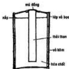
Dùng kìm để bóc đi áo ngoài của pin là vỏ sắt hoặc giấy. Bên trong là vỏ trắng bạc, tiếp tục bóc ra, bạn thấy ở giữa miếng nhựa hình trụ có một lõi màu đen đó là thoi than. Phía đáy của pin là miếng sắt và được gắn liền với vỏ kẽm.
