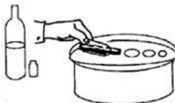
Vòng tròn khói thuốc là một hình thức cuộn xoáy của dòng khí. Mọi chất di chuyển với tốc độ cao qua lỗ nhỏ, khe hẹp, khi thoát ra đều hình thành từng cuộn xoáy hình vòng tròn. Đó cũng là những vòng tròn dưới nước mà chúng ta nhìn thấy trong chậu nước.
