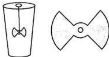
Giải thích: Cánh quạt quay được là do có đối lưu của nước trong cốc. Nhiệt độ nước ở miệng cốc và thành cốc thấp hơn nhiệt độ nước ở giữa cốc khiến nước ở xung quanh chuyển động xuống dưới cốc, nước nóng lên ở giữa thì trồi hướng lên trên. Sự lưu động của nước như vậy đẩy cánh quạt xoay tròn. Cánh quạt quay được là do tác dụng của lực; có điều năng lượng tạo nên lực đó tồn trữ ở phần giữa cốc
