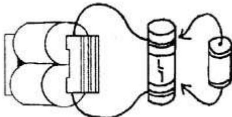
Chúng ta biết để bóng đèn nêông sáng lâu, hai đầu ống đèn tối thiểu phải có điện áp 70 vôn, một chiếc pin chỉ có điện áp 1,5 vôn thì không thể trực tiếp làm ống đèn nêông phát sáng. Vậy chớp sáng là do bóng đèn cao áp phát sáng trong vòng dây của chỉnh lưu trong khoanh khắc tạo ra. Đèn huỳnh quang là dựa vào cao áp tới trên 1000 vôn, phát sinh ở chỉnh lưu mà làm sáng đèn.
