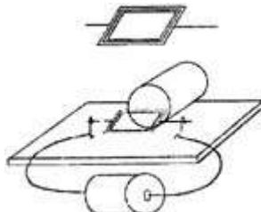
Đặt một dây trên giá đỡ thì một mặt của nó hướng xuống dưới; cạo sơn của hai đầu dây của cuộn dây hướng xuống phía dưới. Cuối cùng mang sắt từ (nam châm) có định ở một phía của cuộn dây. Nối pin với hai chân giá kim loại (chiếc ghim), điện sẽ truyền vào quận dây làm nó tự động quay. Có thay đổi cực âm, dương của pin thì vòng dây vẫn quay, tuy sẽ thay đổi tự động hướng quay.
