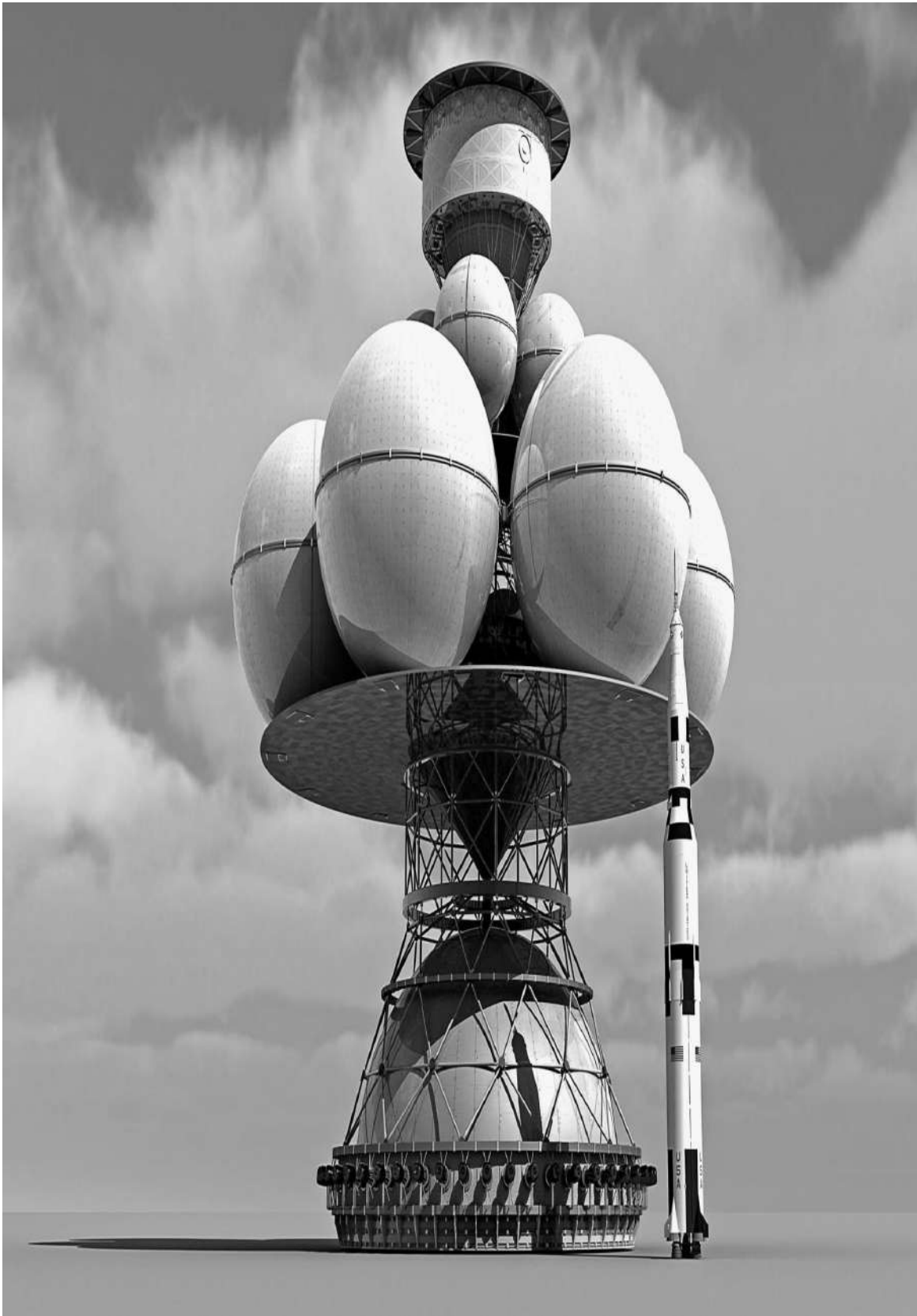
Ảnh trên so sánh kích thước của tàu liên sao nhiệt hạch Daedalus với tên lửa Saturn V. Với kích thước lớn thế này, nhiều khả năng nó phải được lắp ráp ngoài không gian bằng robot.
