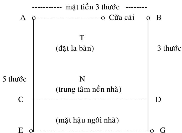
Coi theo hình trên thà A, B, E, G là chu vi trọn cái nền nhà: chiều dọc 5 thước dài hơn chiều ngang chỉ có 3 thước, trung tâm của nó tại N. Còn A, B, C, D là chu vi của hình vuông vức bốn bê bằng nhau, bê nào cũng 3 thước bằng với chiều ngang của mặt tiền, trung tâm của nó ở tại T. Vậy phải đặt la bàn tại trung tâm T mà so cung điểm hướng cho Cửa cái, chớ đặt la bàn tại N là trung tâm của nền nhà.
